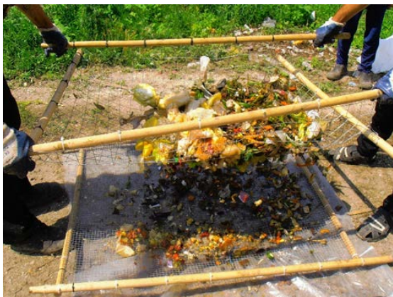
Figura 1-3: Cernere prin sită cu diametrul ochiurilor de 40 mm
