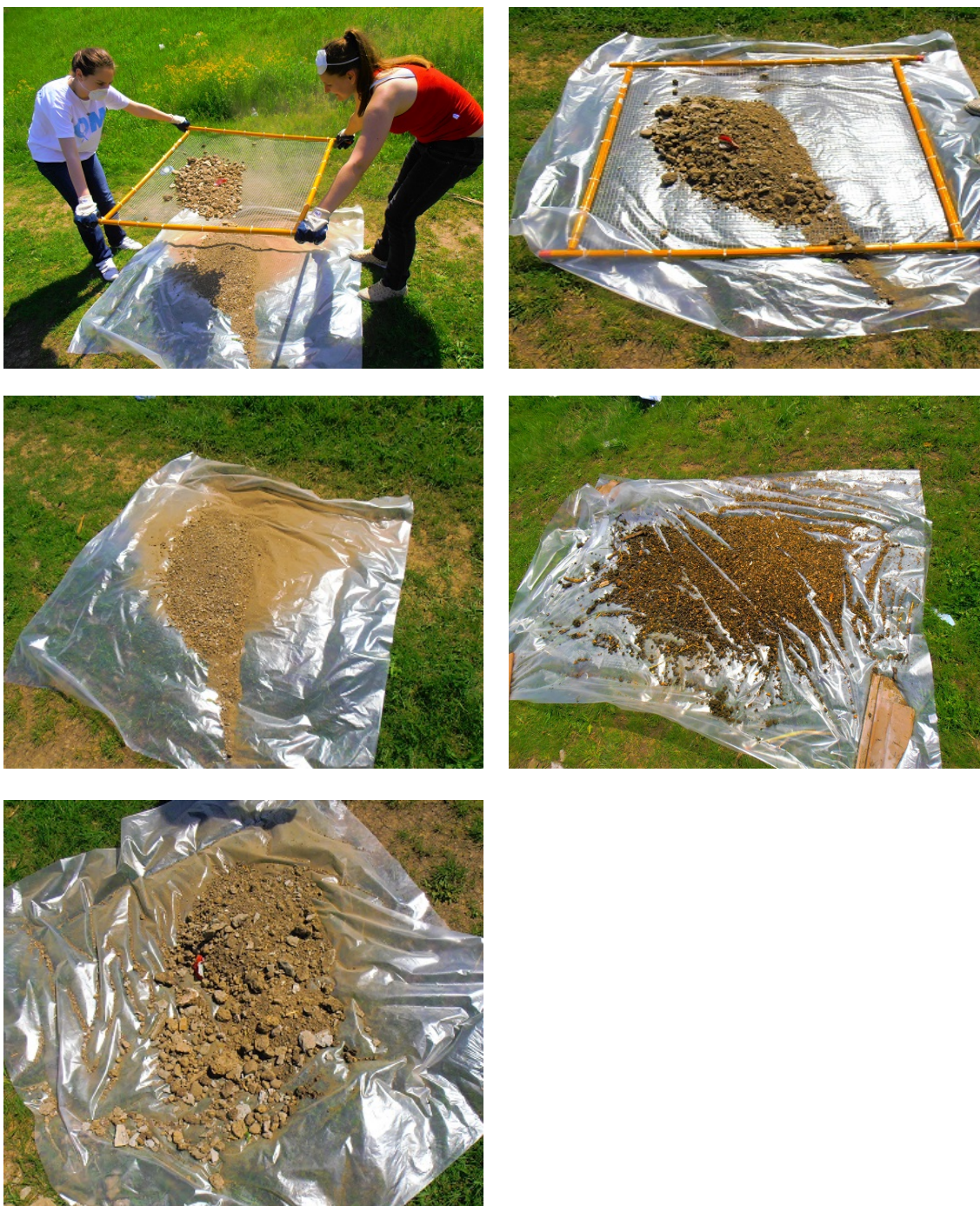
Figura 2-3: Cernere prin sită cu diametrul ochiurilor de 10 mm
