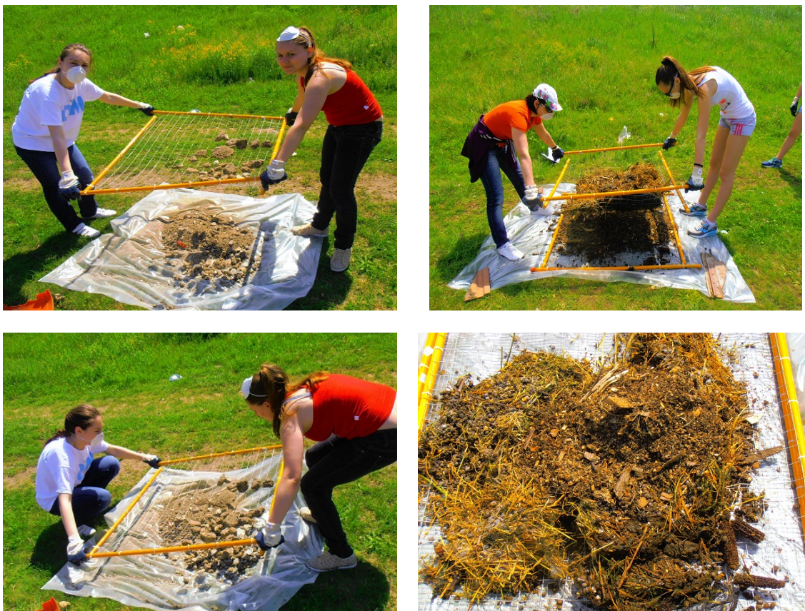
Figura 2-2: Cernere prin sită cu diametrul ochiurilor de 40 mm
